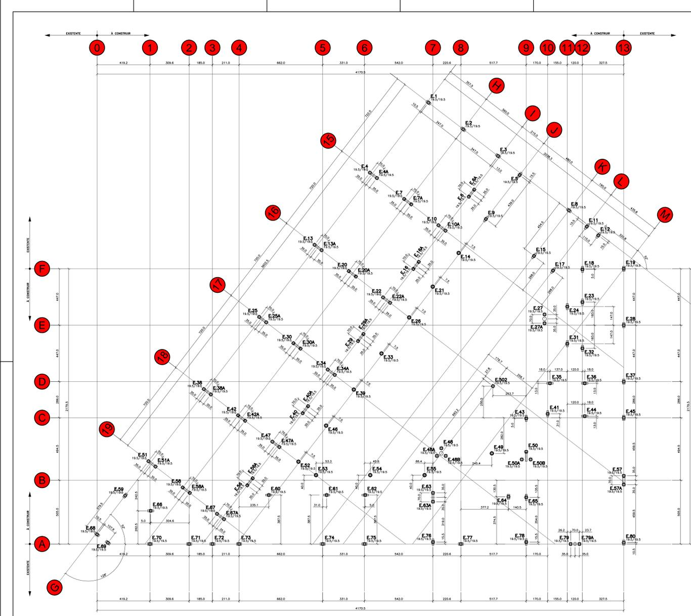
PLANTA DE FUNDAÇÃO - LOCAÇÃO DAS ESTACAS PRÉ-MOLDADAS (19.5x19.5)
