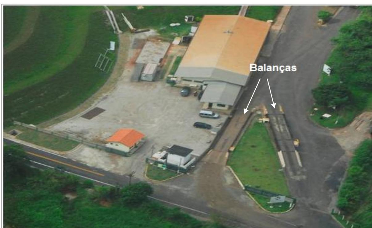
Figura 3.3.1.3.5 - Balanças para pesagem dos caminhões.
