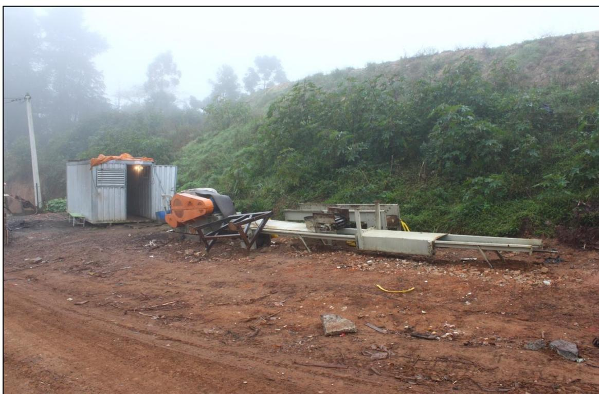
Figura 3.3.4.4 - Equipamento de Trituração de Material vegetal e poda.
