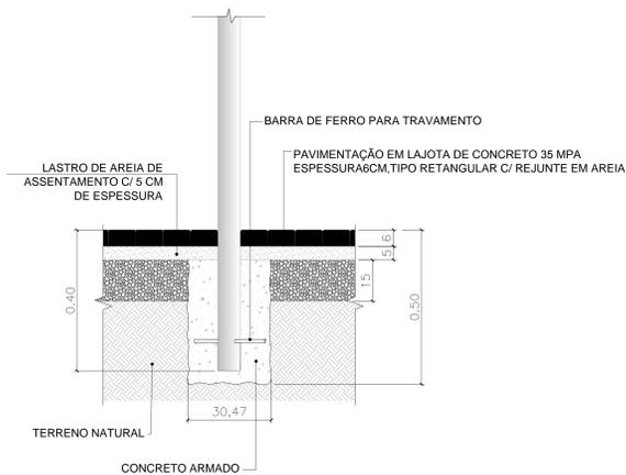
DETALHE FIXAÇÃO DAS PLACAS
