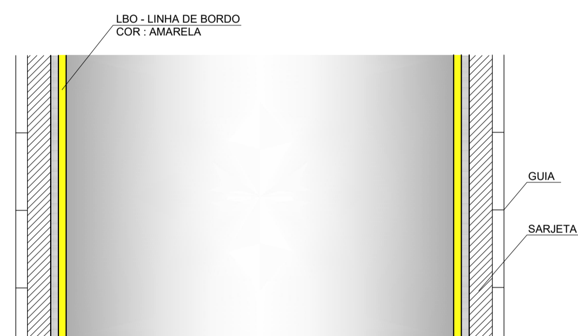
DET. DA PINTURA DE SINALIZAÇÃO HORIZONTAL Escala 1/50
