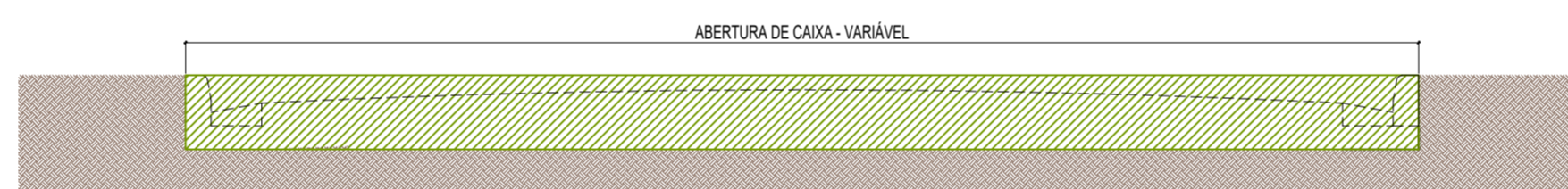
PERFIL TRANSVERSAL ABERTURA DE CAIXA Escala 1/40
