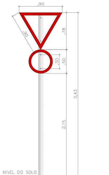
**DETALHE FIXAÇÃO DAS PLACAS - REGULAMENTAÇÃO**
