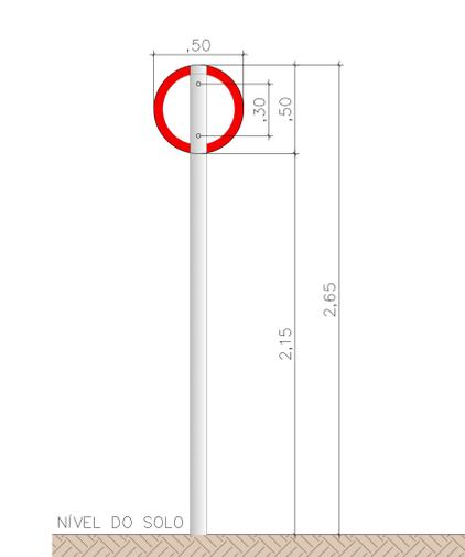
**DETALHE FIXAÇÃO DAS PLACAS - REGULAMENTAÇÃO**
