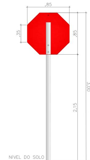
**DETALHE FIXAÇÃO DAS PLACAS - REGULAMENTAÇÃO**
